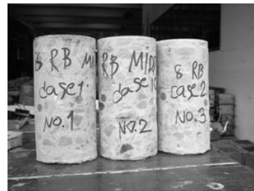
ภาพที่ 6 แท่งตัวอย่างคอนกรีตที่ได้จากการเจาะแก่น
