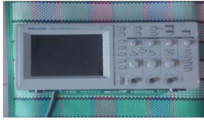
ภาพประกอบ16 ออสซิลโลสโคปแบบดิจิตอลของTektronix
