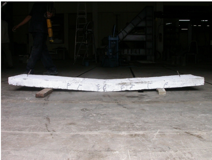
ภาพประกอบ 4.26 ลักษณะการแตกของชิ้นส่วนพื้นตัวอย่างที่เสริมด้วยเหล็กเส้น RB9 (SR-24) ที่ไม่ได้มาตรฐาน
