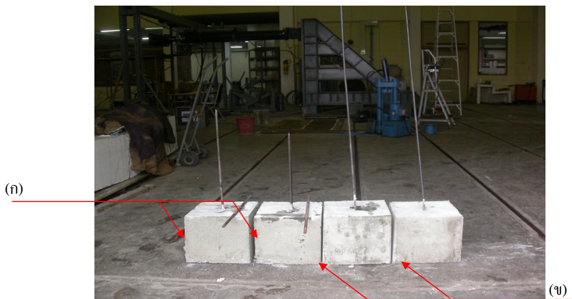
ภาพประกอบ 4.27 ลักษณะการดึงของชิ้นตัวอย่างทดสอบแบบ Pullout
