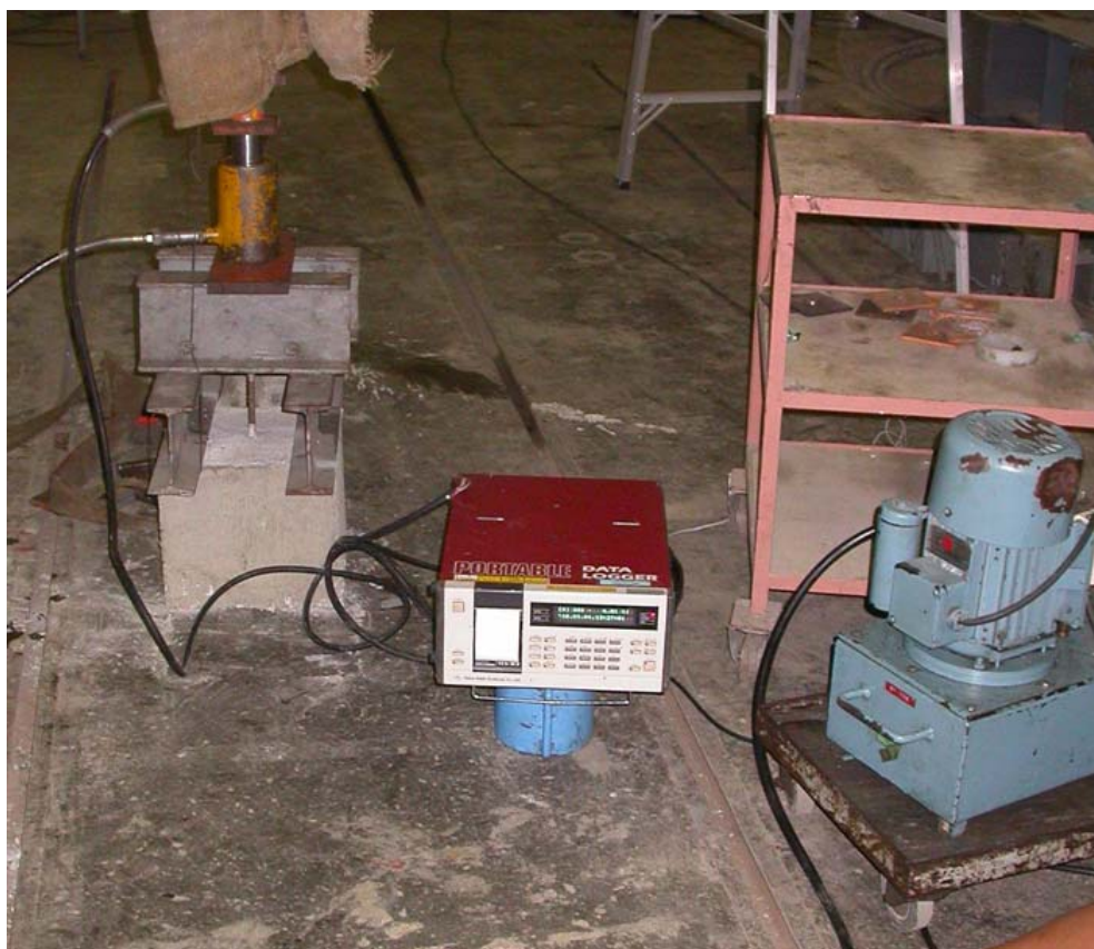
ภาพประกอบ 3.9 แสดงการติดตั้งอุปกรณ์สำหรับการทดสอบแบบ Pullout
