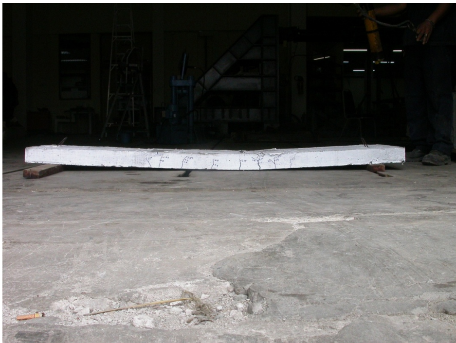
ภาพประกอบ 4.24 ลักษณะการแตกของชิ้นส่วนพื้นตัวอย่างที่เสริมด้วยเหล็กเส้น RB9 (SR-24) ที่ได้มาตรฐาน
