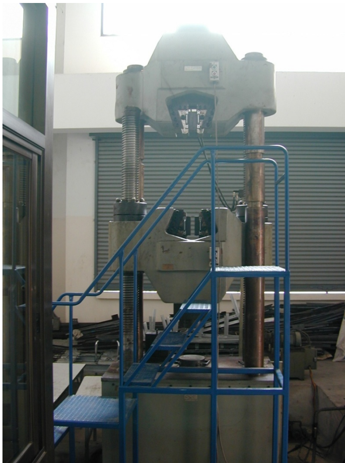
ภาพประกอบ 3.3 เครื่องทดสอบคุณสมบัติทางกลอเนกประสงค์ Shimadzu ขนาด 200 ตัน
