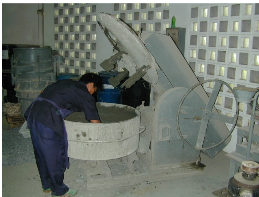
ภาพประกอบ 3.4 โม่ผสมคอนกรีตที่ใช้ (ห้องปฏิบัติการ โครงสร้าง สถาบันเทคโนโลยีแห่งเอเชีย)
