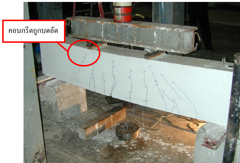
ภาพประกอบ 4.16 ลักษณะการแตกของชิ้นส่วนคานตัวอย่างที่เสริมด้วยเหล็กเส้น DB12 (SD-30) ที่ได้มาตรฐาน
