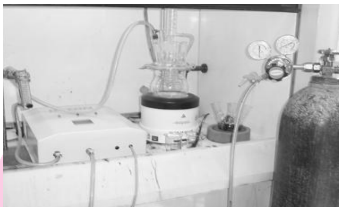
รูปที่ 3.7 การออกซิไดส์ไอโชนใน reflux column
