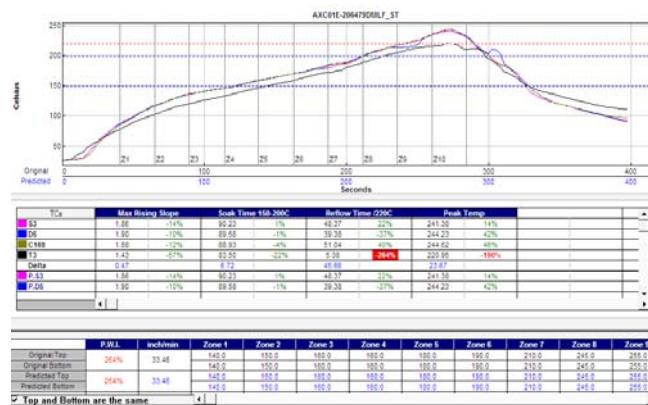
ภาพที่ 2 แสดง Thermal profile ของตัวอุปกรณ์ PBGA ด้วยเครื่องบันทึกอุณหภูมิ KIC 2000
