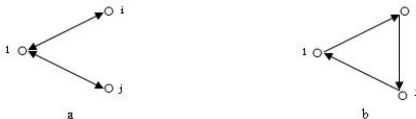
ภาพประกอบ 4 a เส้นทางการเดินทางแบบเดิม และ b เส้นทางการเดินทางแบบเซฟวิ้ง
