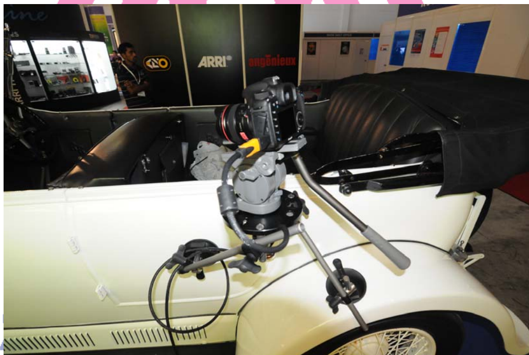
ภาพประกอบที่ 120 กล้อง DSLR Canon 7D จับยึดกับรถยนต์ ที่มา : รัฐสภา แก่นแก้ว,2553 : บันทึกภาพจากงาน Broadcast Asia 2010,Singapore
