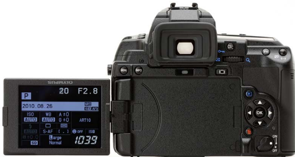
ภาพประกอบที่ 112 จอ LCD ที่สามารถพลิกได้ของ กล้อง Olympus E-5 ที่มา : http://a.img-dpreview.com/reviews/OlympusE5/images/screenout.jpg
