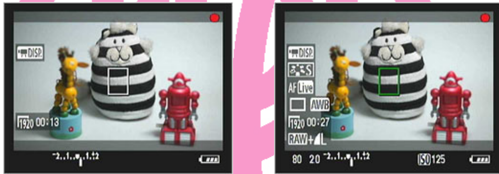
ภาพประกอบที่ 47 LCD ของกล้อง DSLR Canon EOS 5D Mark II เมื่อใช้บันทึกวีดิทัศน์ ที่มา : http://www.dpreview.com/reviews/canoneos5dmarkii/page19.asp
