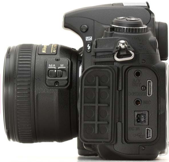
ภาพประกอบที่ 21 ช่องรับสัญญาณของกล้อง DSLR Nikon D300s ที่มา : http://a.img-dpreview.com/reviews/nikond300s/images/Portsopen.jpg
