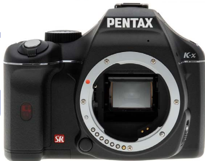
ภาพประกอบที่ 92 กระจกสะท้อนภาพของ Pentax K-x ที่มา : http://www.imaging-resource.com/PRODS/KX/ZURFRONT-L.JPG
