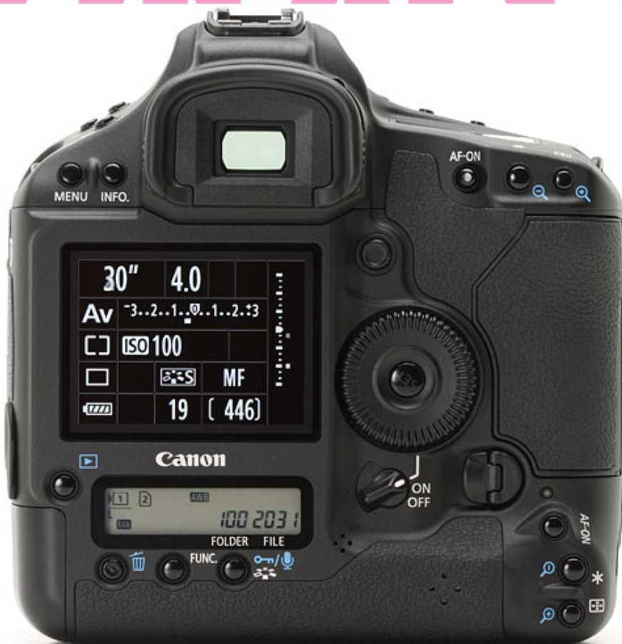
ภาพประกอบที่ 67 การแสดงค่าการสั่งงานในจอ LCD ของ Canon EOS 1D Mark ที่มา : http://www.dpreview.com/reviews/canoneos1dmarkiv/page8.asp
