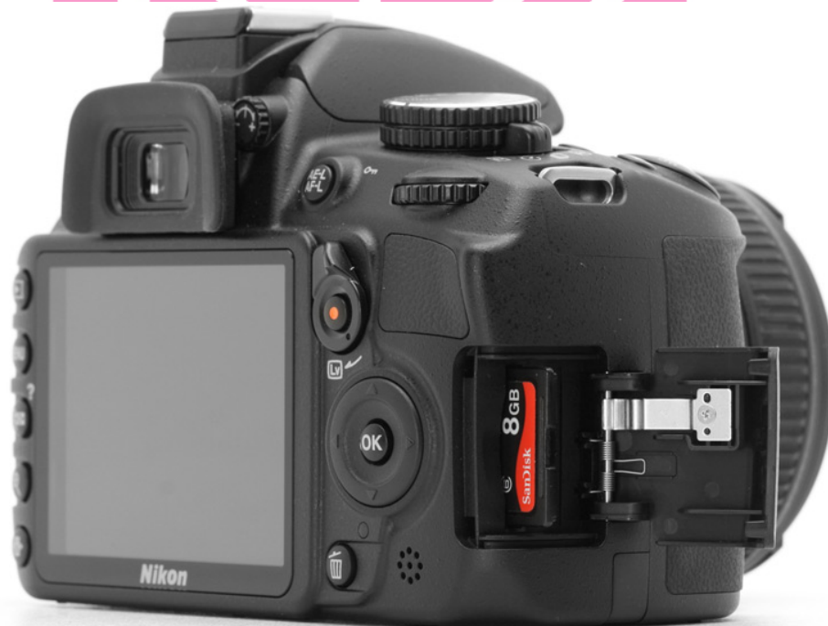
ภาพประกอบที่ 33 ช่องใส่สื่อบันทึกของ DSLR Nikon D3100 ที่มา : http://a.img-dpreview.com/previews/nikond3100/Images/card.jpg
