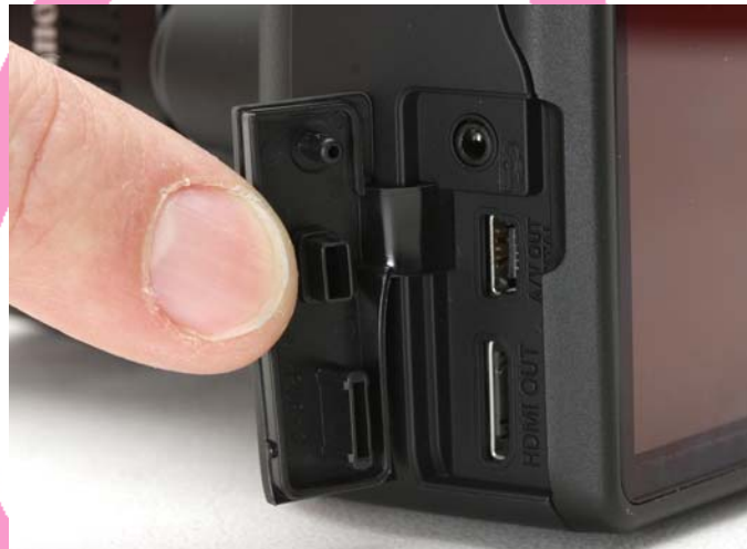
ภาพประกอบที่ 53 ช่องต่อสัญญาณของ DSLR Canon EOS 500D ที่มา : http://a.img-dpreview.com/reviews/CanonEOS500D/Images/connector2.jpg
