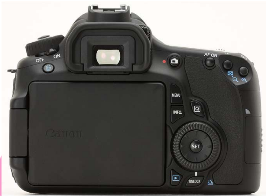
ภาพประกอบที่ 79 LCD ของ Canon EOS 60D เมื่อพับปิดเก็บ ที่มา : http://a.img-dpreview.com/previews/CanonEOS60D/images/backclosed.jpg
