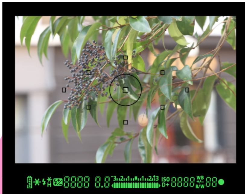
ภาพประกอบที่ 82 ระบบอัตโนมัติโฟกัส 9 จุด แบบ Cross-type ของกล้อง EOS 60D ที่มา : http://www.dpreview.com/previews/canoneos60d/page3.asp
