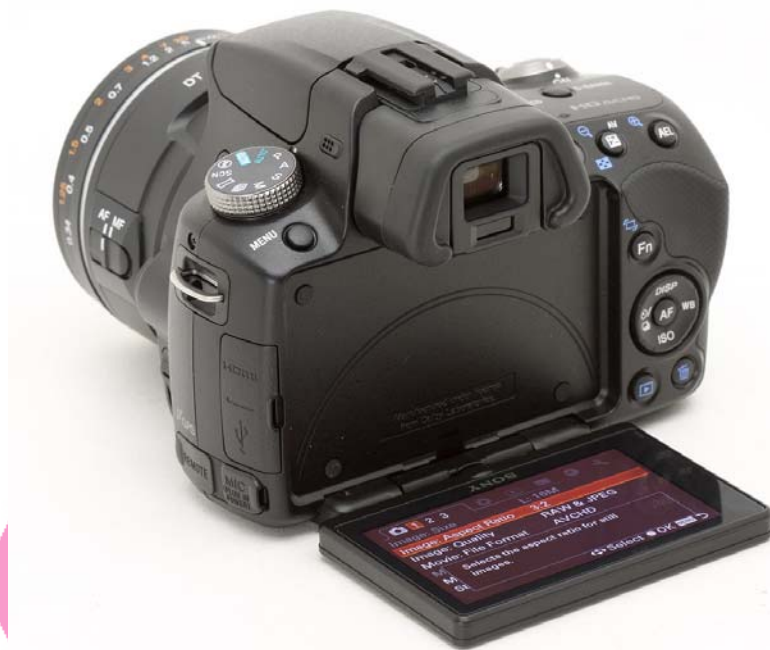
ภาพประกอบที่ 104 จอ LCD ของกล้อง DSLR Sony \alpha 55 ที่สามารถพับ พลิก และหมุนได้ ที่มา : http://www.dpreview.com/reviews/Sonyslta55/images/screen3.jpg
