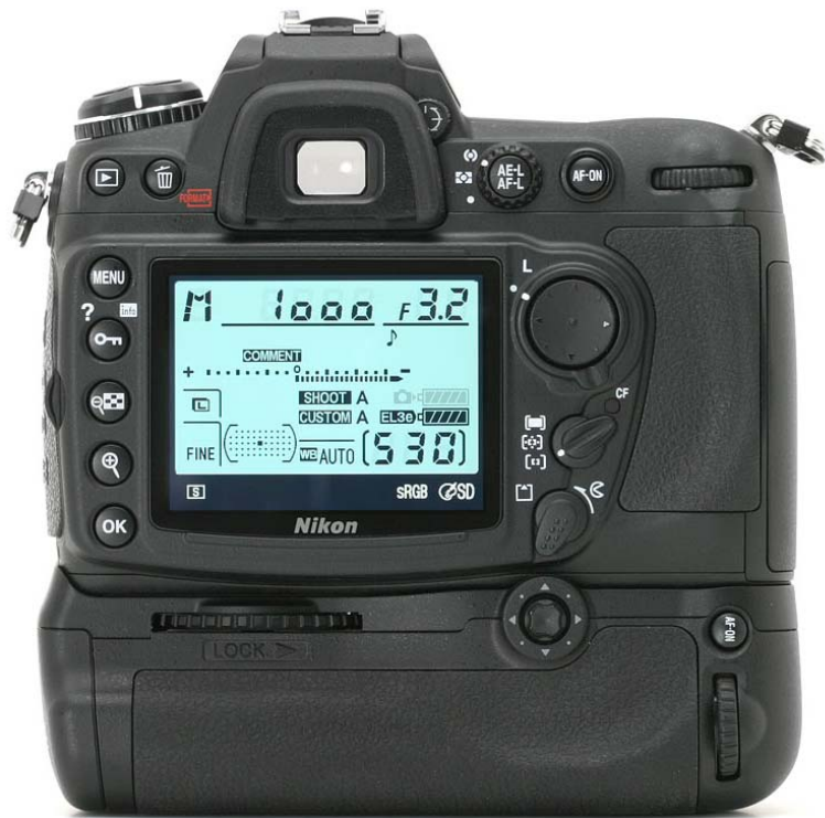
ภาพประกอบที่ 22 กล้อง DSLR Nikon D300s เมื่อติดตั้งกับ MB-D10 ที่มา : http://a.img-dpreview.com/reviews/NikonD300/Images/withgrip02.jpg
