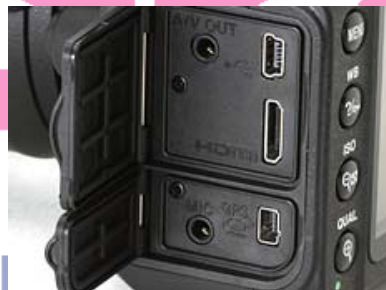
ภาพประกอบที่ 42 ช่องต่อสัญญาณของกล้อง DSLR Nikon D7000
