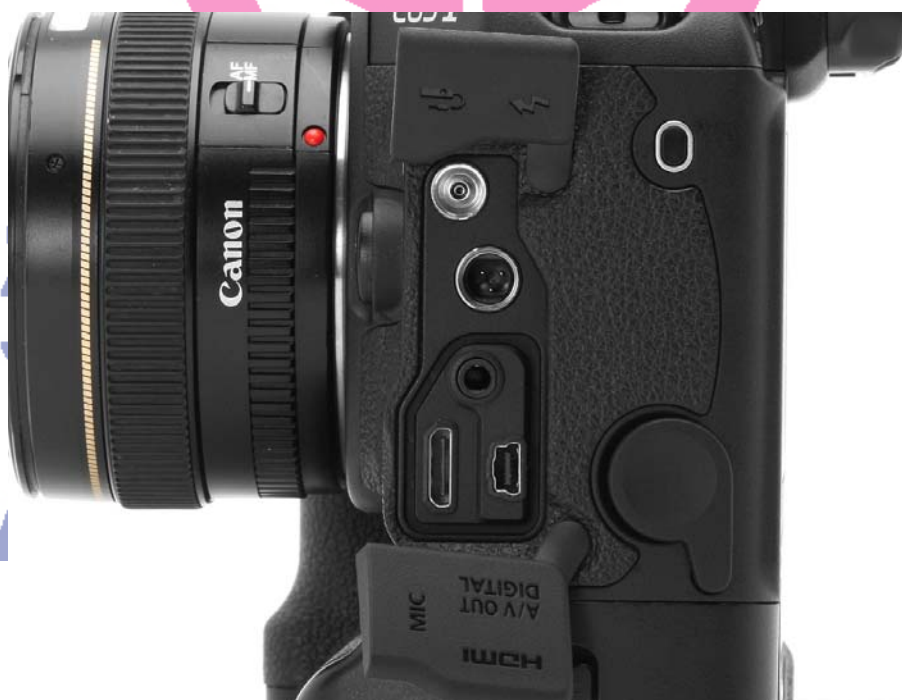
ภาพประกอบที่ 66 ช่องรับสัญญาณของกล้อง DSLR Canon EOS 1D Mark IV ที่มา : http://a.img-dpreview.com/reviews/CanonEOS1DMarkIV/Images/Portsoopen.jpg
