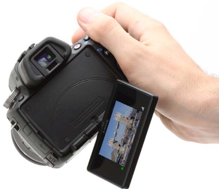
ภาพประกอบที่ 104 จอ LCD ของกล้อง DSLR Sony \alpha 55 ที่สามารถพับ พลิก และหมุนได้ ที่มา : http://www.dpreview.com/reviews/Sonyslta55/images/screen3.jpg
