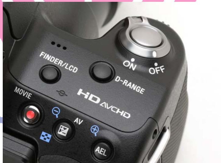
ภาพประกอบที่ 108 ปุ่มสั่งงานบันทึกวีดิทัศน์ของกล้อง DSLR Sony \alpha 55
