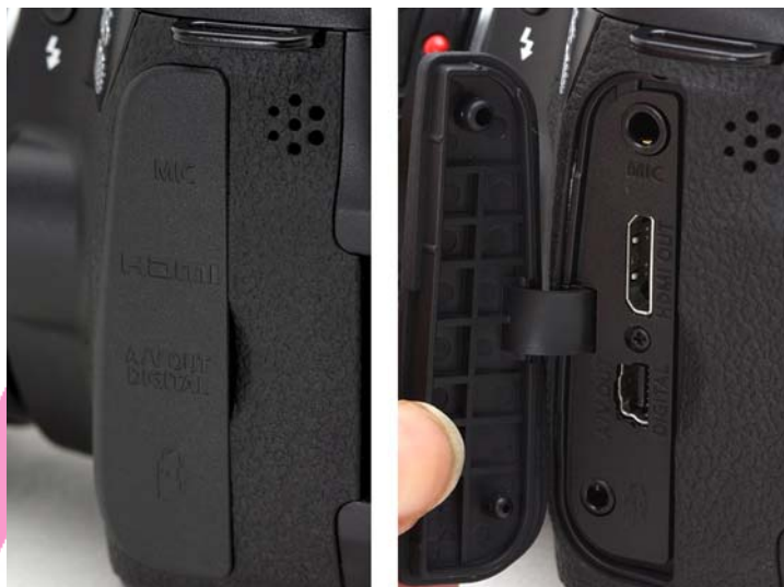
ภาพประกอบที่ 84 ช่องต่อสัญญาณของ กล้อง Canon EOS 60D ที่มา : http://a.img-dpreview.com/previews/CanonEOS60D/images/ports.jpg
