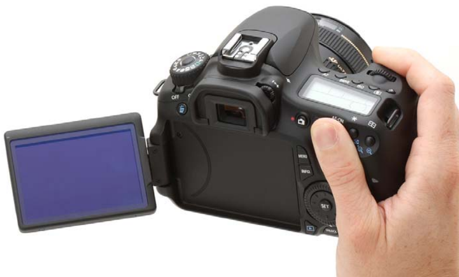
ภาพประกอบที่ 78 LCD ของ Canon EOS 60D ปรับหมุนและพลิกได้ 540 องศา ที่มา : http://a.img-dpreview.com/previews/CanonEOS60D/images/inhand-tiltedscreen.jpg
