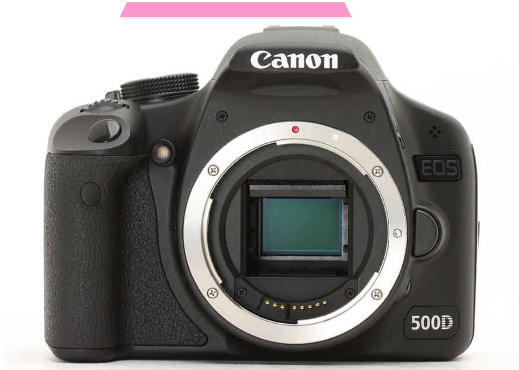
ภาพประกอบที่ 51 Sensor ขนาด APS-C เมื่อบรรจุใน DSLR Canon EOS 500D
