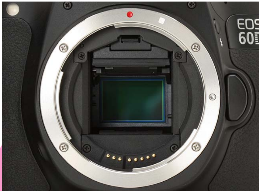
ภาพประกอบที่ 77 CMOS Sensor ขนาด APS-C ติดตั้งใน Canon D60 ที่มา : http://a.img-dpreview.com/reviews/CanonEOS60D/images/lensmount2.jpg
