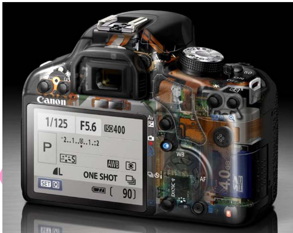
ภาพประกอบที่ 115 ส่วนประกอบภายใน (ด้านหลัง) ของกล้องส่องถ่ายภาพเลนส์เดี่ยวแบบดิจิทัล (DSLR) ที่สามารถบันทึกวีดิทัศน์ได้ ผลิตภัณฑ์ตราสินค้า Canon รุ่น EOS 500D ที่มา : http://a.img-dpreview.com/reviews/CanonEOS500D/Images/specsview02.jpg
