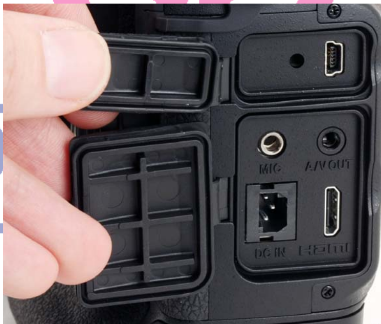
ภาพประกอบที่ 26 ช่องต่อสัญญาณภาพและเสียงของ Nikon D3s
