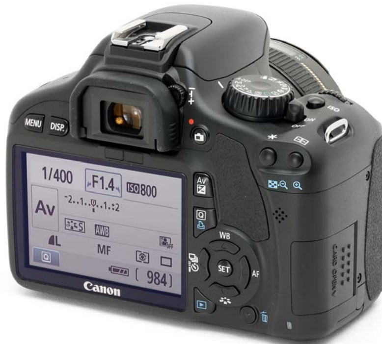
ภาพประกอบที่ 71 ปุ่มสั่งงานด้านหลังของ DSLR Canon EOS 550D ที่มา : http://a.img-dpreview.com/reviews/CanonEOS550D/images/back3q.jpg
