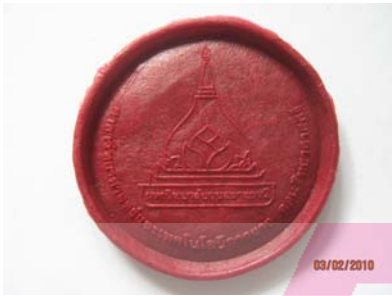
ภาพที่ 4 จานรองแก้วที่ทำมาจากพลาสติกชีวภาพ : กลูเทนต่อกลีเซอรอลในอัตราส่วน 95:5 เปอร์เซนต์โดยน้ำหนัก
