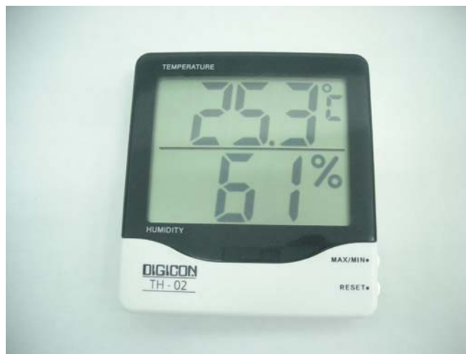
ภาพประกอบที่ ง.2 Thermo/Hygrometer ยี่ห้อ Digicon TH-02 temperature -10^{\circ}\text{C} to +60^{\circ}\text{C} humidity 10-99%
