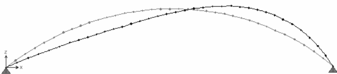
รูปที่ 18 แสดงรูปทรงที่เปลี่ยนไป (Deformed Shape) ซึ่งได้จากการวิเคราะห์แบบ P-Delta ในกรณีน้ำหนักบรรทุกเต็มช่วง (Full Span) ขนาด 60 \text{ kg/m}^2
