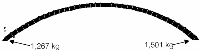
รูปที่ 24 แผนผังแรงตามแนวแกน (Axial Force) กรณีน้ำหนักบรรทุกครึ่ง ช่วง (Half Span) ขนาด 40 \text{ kg/m}^2
