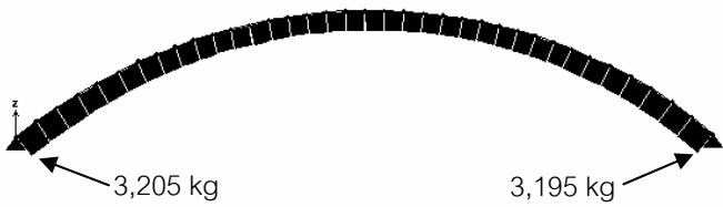
รูปที่ 21 แผนผังแรงตามแนวแกน (Axial Force) ต่อความกว้าง 0.30 เมตร (1 ชั้น) กรณีน้ำหนักบรรทุกทุกเต็มช่วง (Full Span) 60 \text{ kg/m}^2
