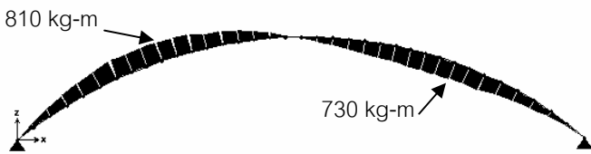
รูปที่ 23 แผนผังโมเมนต์ดัด (Bending Moment Diagram) ต่อความกว้าง 0.30 เมตร (1 ชั้น) กรณีน้ำหนักบรรทุกครึ่งช่วง (Half Span) ขนาด 40 \text{ kg/m}^2
