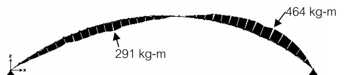
รูปที่ 20 แผนผังโมเมนต์คัต (Bending Moment Diagram) ต่อความกว้าง 0.30 \text{ เมตร (1 ชั้น)} กรณีน้ำหนักบรรทุกเต็มช่วง (Full Span) 60 \text{ kg/m}^2
