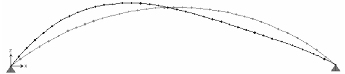
รูปที่ 19 แสดงรูปทรงที่เปลี่ยนไป (Deformed Shape) ซึ่งได้จากการวิเคราะห์แบบ P-Delta ในกรณีน้ำหนักบรรทุกครึ่งช่วง (Half Span) ขนาด 40 \text{ kg/m}^2
