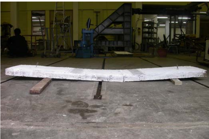
ภาพที่ 10 ตัวอย่างพื้นที่เสริมด้วยเหล็ก RB6 ที่ได้มาตรฐาน
