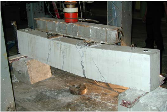
ภาพที่ 9 กานตัวอย่างที่เสริมด้วยเหล็ก DB12 ที่ไม่ได้มาตรฐาน
