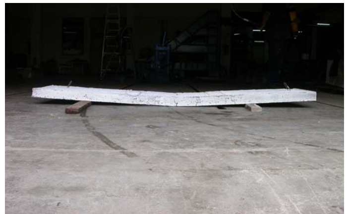
ภาพที่ 13 ตัวอย่างพื้นที่เสริมด้วยเหล็ก RB9 ที่ไม่ได้มาตรฐาน
