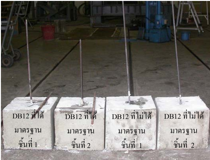
ภาพที่ 14 ลักษณะการพังของชิ้นตัวอย่างทดสอบแบบ Pullout
