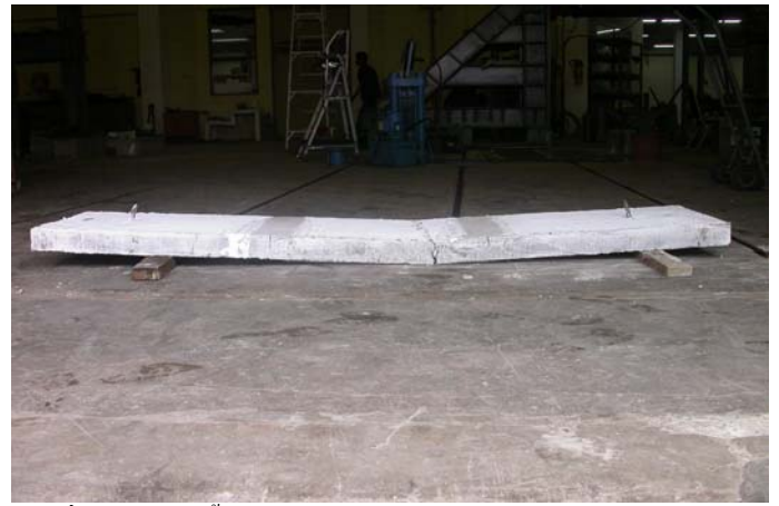
ภาพที่ 11 ตัวอย่างพื้นที่เสริมด้วยเหล็ก RB6 ที่ไม่ได้มาตรฐาน
