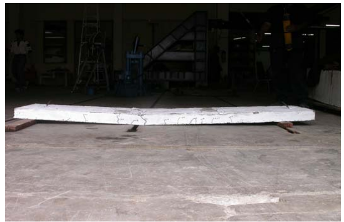
ภาพที่ 12 ตัวอย่างพื้นที่เสริมด้วยเหล็ก RB9 ที่ได้มาตรฐาน
