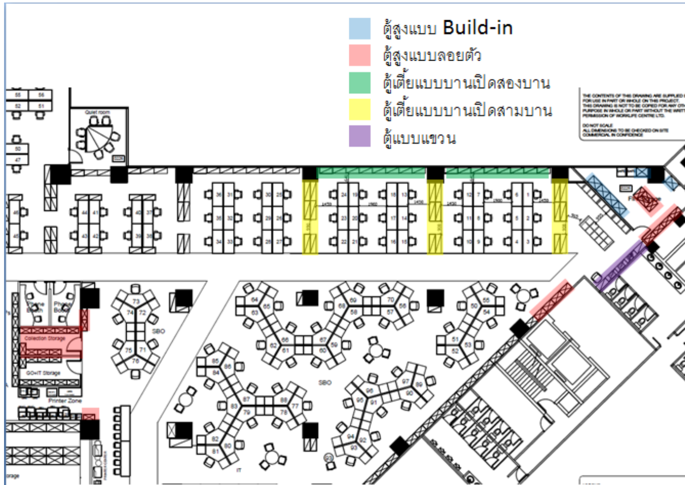
รูปภาพประกอบที่ 6 แสดงตำแหน่งของตู้เอกสารประเภทต่างๆ
