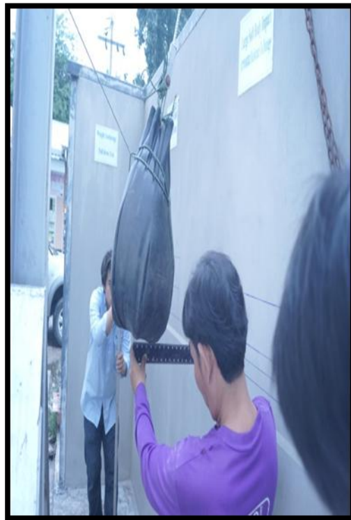
ภาพประกอบที่ 4.2 – 4.3 การทดสอบแบบ Resistance to Damage
