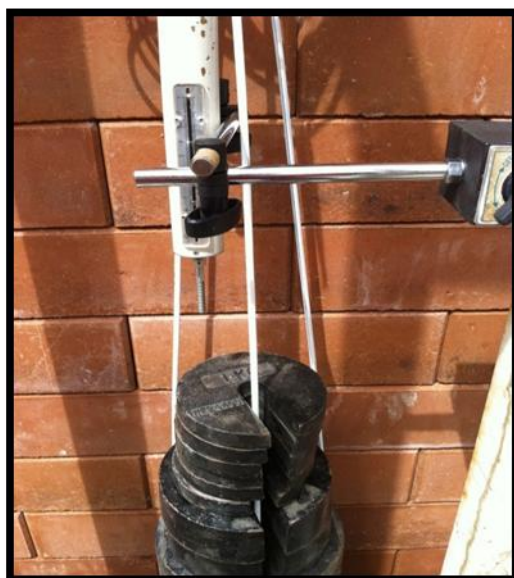
ภาพประกอบที่ 4.9 - 4.10 การทดสอบ แบบ Light Weight Anchorage
