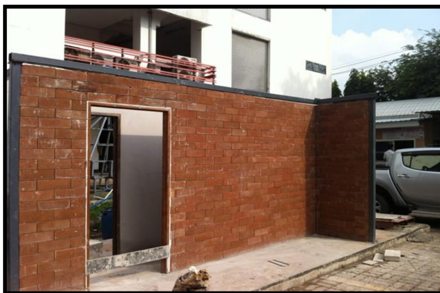
ภาพประกอบที่ 4.4 ผนังอิฐบล็อกประสานที่ทดสอบ
