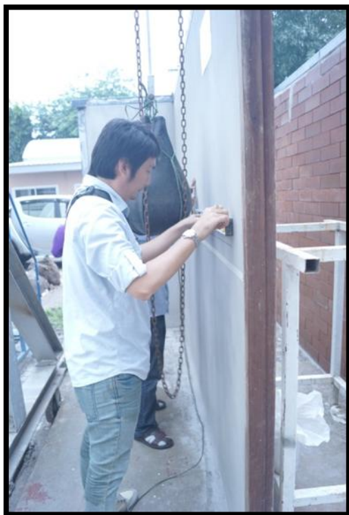
ภาพประกอบที่ 4.2 – 4.3 การทดสอบแบบ Resistance to Damage
