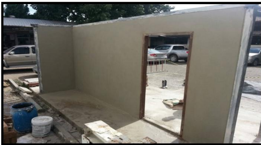
ภาพประกอบที่ 4.1 ผนังก่ออิฐมอญ-ฉาบปูนที่ทดสอบ
