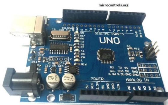
ภาพที่ 3.4 บอร์ดอาร์ดูโน้ ยูโน้ Arduino uno
