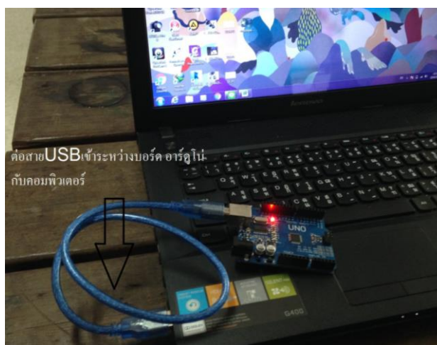
ภาพที่ 4.9 การต่อสายระหว่างบอร์ดไมโครคอนโทรลเลอร์อาร์ดูโน้ กับพอร์ต USB ของคอมพิวเตอร์
