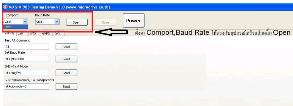
ภาพที่ 4.4 ตั้งค่า Comport และ Baud Rate ของโปรแกรมMD SIM 908 Testing Demo
