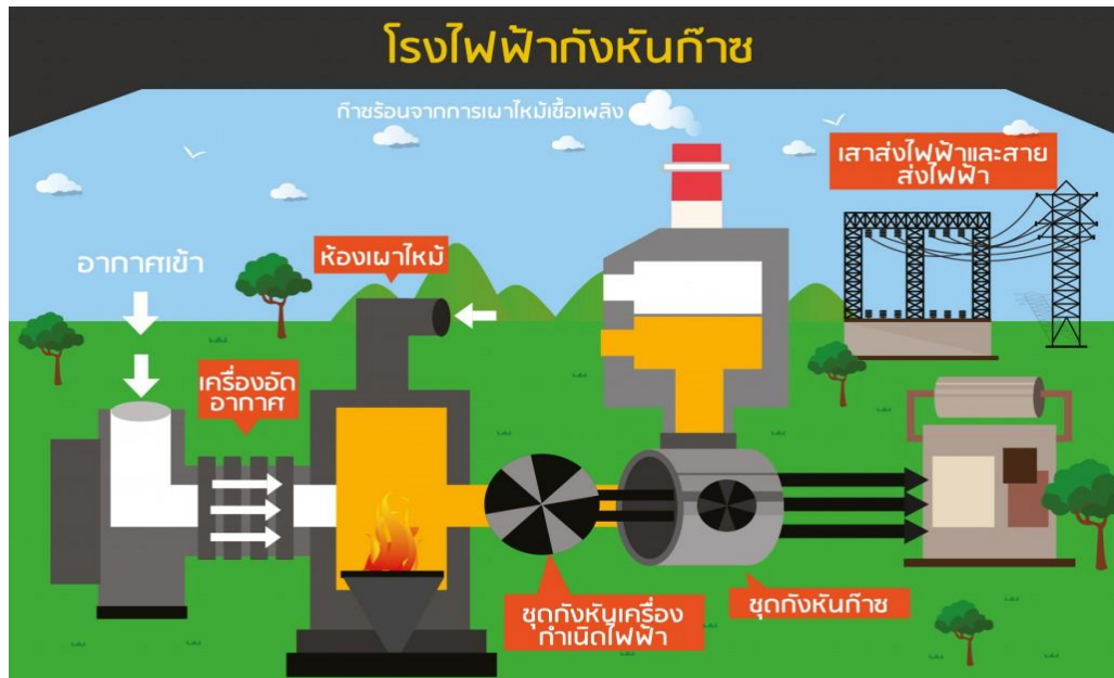
ภาพที่ 2.2 หลักการทำงานของโรงไฟฟ้ากังหันก๊าซ
