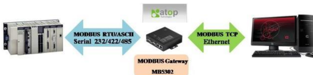
ภาพที่ 2.51 การแปลง Modbus Serial เป็น Modbus Ethernet
