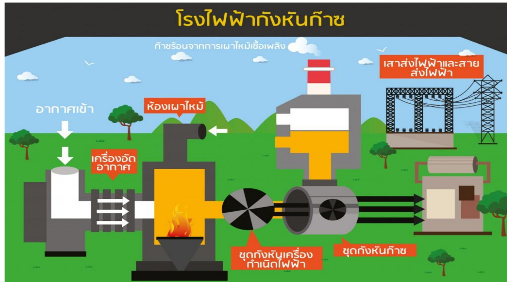
ภาพที่ 2.2 หลักการทำงานโรงไฟฟ้ากังหันก๊าซ
