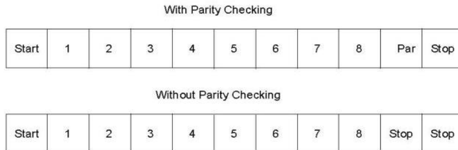
ภาพที่ 2.44 ลักษณะเฟรมข้อมูลของ Modbus Rtu
