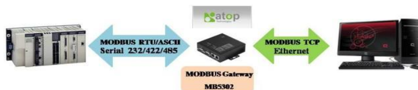
ภาพที่ 2.49 การแปลง Modbus Serial เป็น Modbus Ethernet
