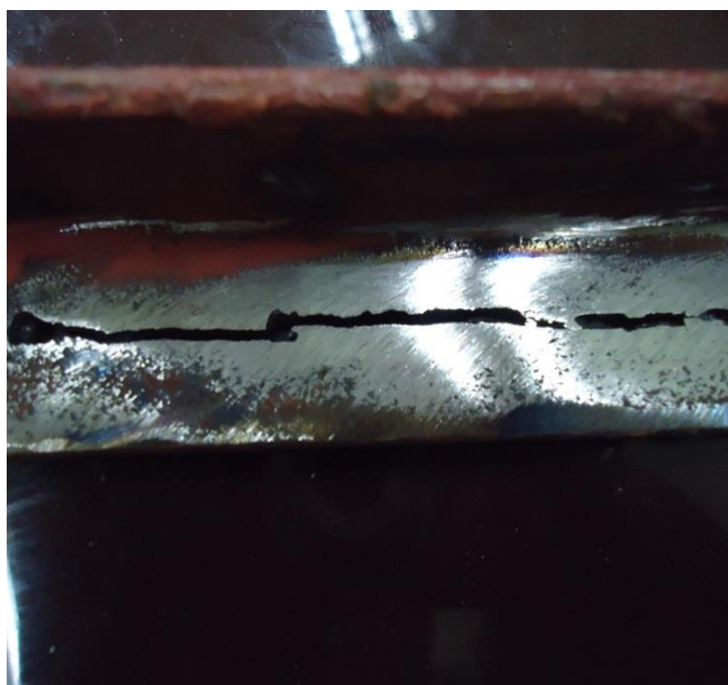
ภาพที่ 4.8 การตัดแผ่นเหล็ก 3 mm. (กระแส 21 A) ความยาวในการลากตัด 10 cm.
