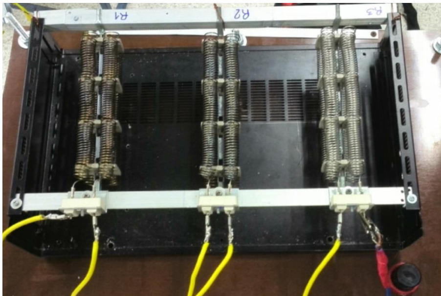
ภาพที่ 4.4 R-load ใช้ทดสอบหาค่า เพื่อออกแบบอิเล็กทรอนิกส์โหลด
