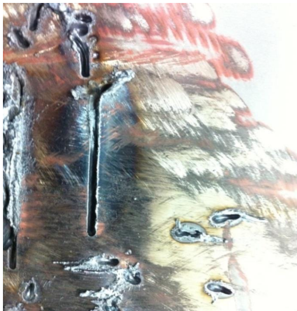
ภาพที่ 4.9 การตัดแผ่นเหล็ก 4 mm. (กระแส 30 A) ความยาวในการลากตัด 10 cm.
