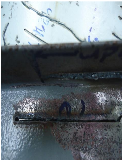
ภาพที่ 4.7 การตัดแผ่นเหล็ก 2 mm. (กระแส 21 A) ความยาวในการลากตัด 10 cm.
