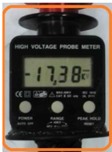
ภาพที่ 4.3 การวัดแรงดันไฟฟ้าสูงด้วย High Volt Probe Meter
