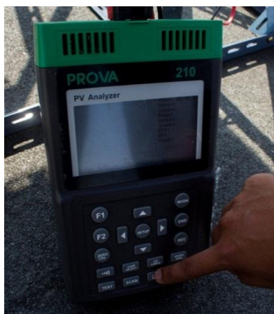
จ. กดปุ่ม Auto scan วัดกำลังงานไฟฟ้า ภาพที่ 4.1 ขั้นตอนการทดลอง
