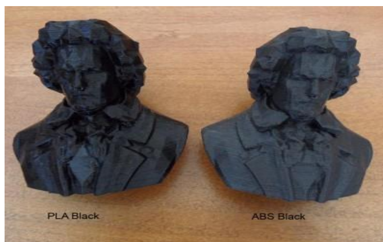
ภาพที่ 2.7 ตัวอย่างชิ้นงานการเปรียบเทียบระหว่าง PLA กับ ABS
