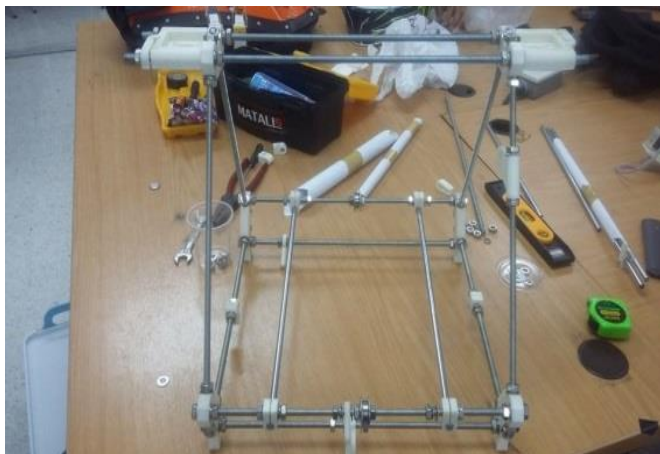
ภาพที่ 3.3 แบบโครงสร้างเมื่อประกอบแกน X, Y, Z
