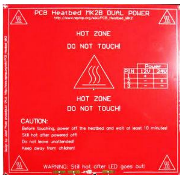
ภาพที่ 3.8 แผ่นความร้อน (Heat Bed)
