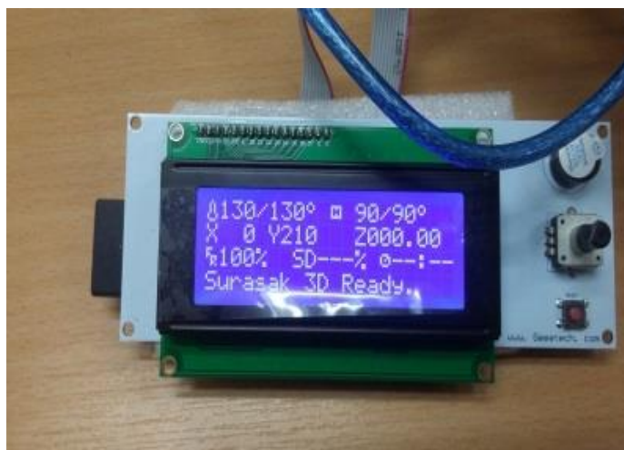
ภาพที่ 4.1 จอแสดงภาพอุณหภูมิที่ทำการตั้ง
