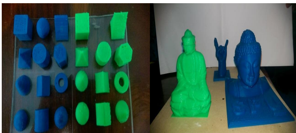
ภาพที่ 4.26 การเปรียบเทียบระหว่างพลาสติก ABS กับ PLA
