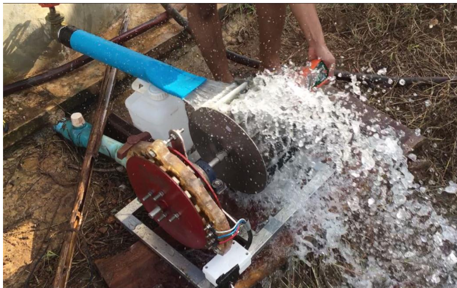
แสดงการทดสอบเครื่องกำเนิดไฟฟ้าที่ใช้น้ำเป็นต้นกำลัง
