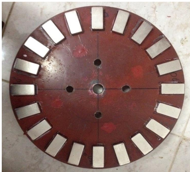
แสดงการติดแม่เหล็กลงบนแผ่นเหล็กเพื่อสร้างโรเตอร์
