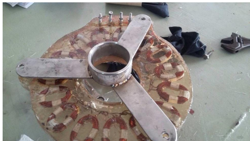
แสดงการติดตั้งชุดขดลวดเข้ากับฐาน
