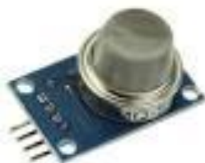
ภาพที่ 3.26 ระบบเซ็นเซอร์ตรวจวัดแก๊สไวไฟ
