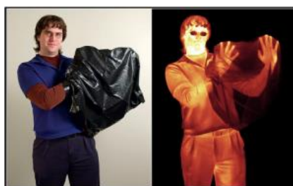
ภาพที่ 2.32 การแผ่รังสีอินฟราเรดของมนุษย์ ที่ถ่ายโดยกล้องถ่ายภาพความร้อน
