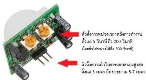
ภาพที่ 2.30 ตัวตั้งการหน่วงเวลาและตัวตั้งความไวในการตอบสนอง
