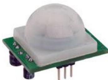
ภาพที่ 2.27 เซ็นเซอร์ตรวจจับความเคลื่อนไหว
