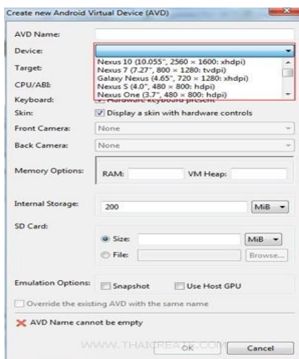
ภาพที่ 2.15 Emulator สามารถเลือกสร้างได้ตาม สมาร์ทโฟน รุ่นต่าง ๆ ได้
