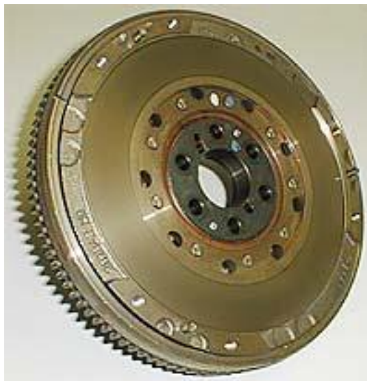
ภาพที่ 2.8 ล้อหมุนกำลังในเครื่องยนต์ที่ทันสมัย
