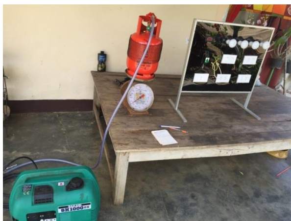
ภาพที่ 4.8 ต่อสายเข้ากับถังแก๊ส
