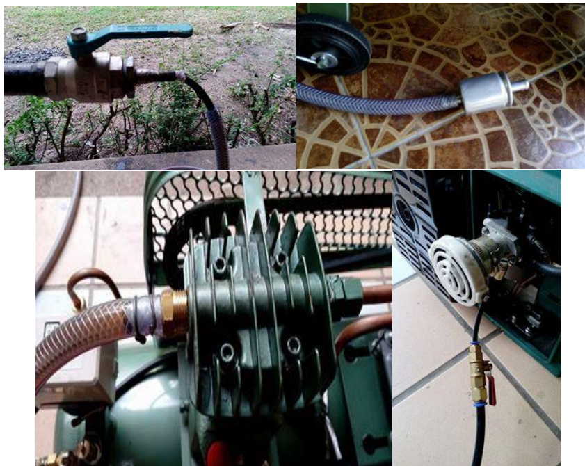
ภาพที่ 4.11 การต่อสายเตาเผาเตาเผา ป้อนลม เครื่องยนต์
