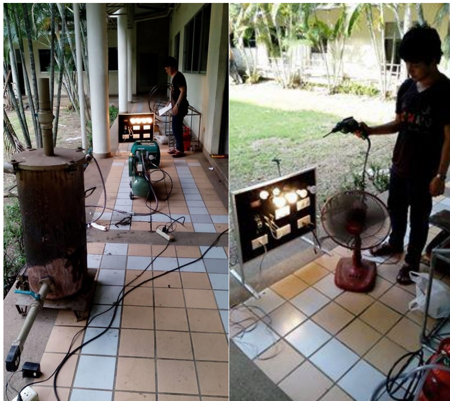
ภาพที่ 4.19 ภาพรวมในการติดตั้งเครื่องยนต์โดยใช้ก๊าซชีววมวล
