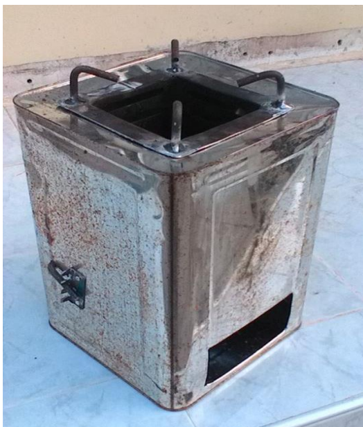
ภาพที่ 2.5 เตาแก๊สชีวมวลแบบใช้ฟืนเป็นเชื้อเพลิง
