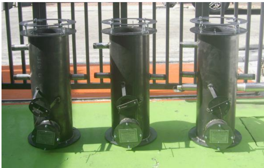
ภาพที่ 2.4 เตาแก๊สชีวมวลแบบใช้กลบเป็นเชื้อเพลิง
