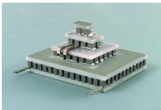
ภาพที่ 2.13 เทอร์โมอิเล็กทริกแบบหลายชั้น (Multistage Module)
