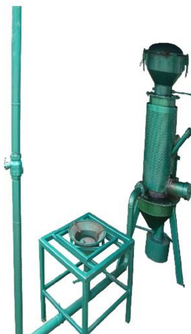
ภาพที่ 2.6 เตาแก๊สชีวมวลแบบใช้ฟืนเป็นเชื้อเพลิงขนาดกลาง
