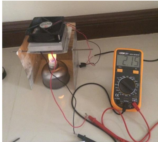
ภาพที่ 4.3 การทดลองเทอร์โมอิเล็กทริกโดยใช้ตะเกียงแอลกอฮอล์ให้อุณหภูมิ
