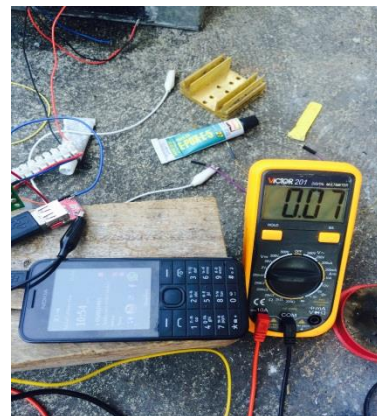
(ก) การวัดแรงดันไฟฟ้าและการต่อภาระทางไฟฟ้า (ข) การวัดกระแสไฟฟ้าและการต่อภาระทางไฟฟ้า
