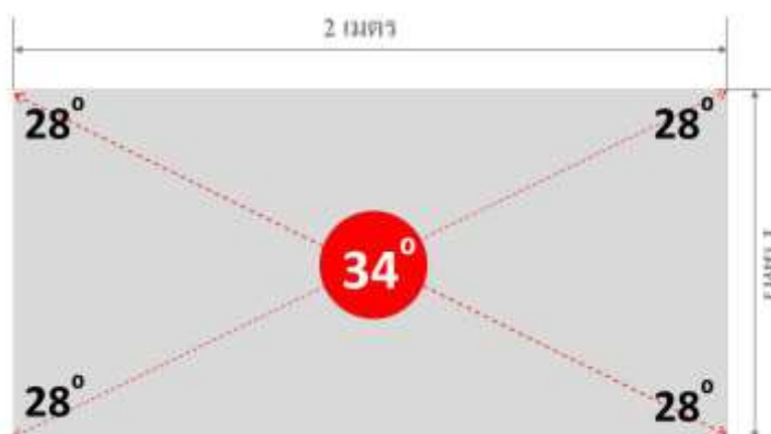
ภาพที่ 1.1 แสดงการกระจายความร้อนภายในคอกกกแบบปัจจุบัน ที่ไม่สามารถให้ความอบอุ่นให้ทั่วทั้งพื้นที่
