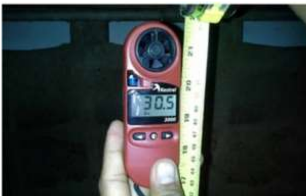
ภาพที่ 1.3 แสดงการวัดอุณหภูมิภายในคอกกล้วยสุกในระดับ 20 เซนติเมตร จากพื้นคอก
