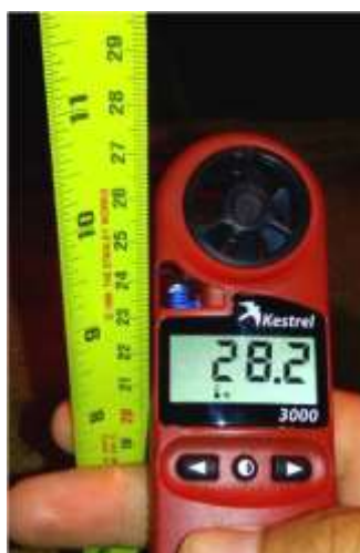
ภาพที่ 4.4 แสดงการวัดอุณหภูมิสูงจากพื้น 20 CM ด้วย (Temperature Control)
