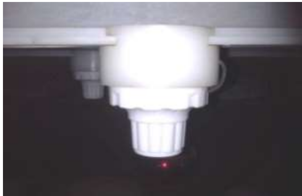
ภาพที่ 4.1 ขั้วหลอดไฟชนิด E70 ขึ้นรูปด้วยพลาสติกซูเปอร์เลน (Super len) เป็นขั้วหลอดไฟอินฟราเรด
