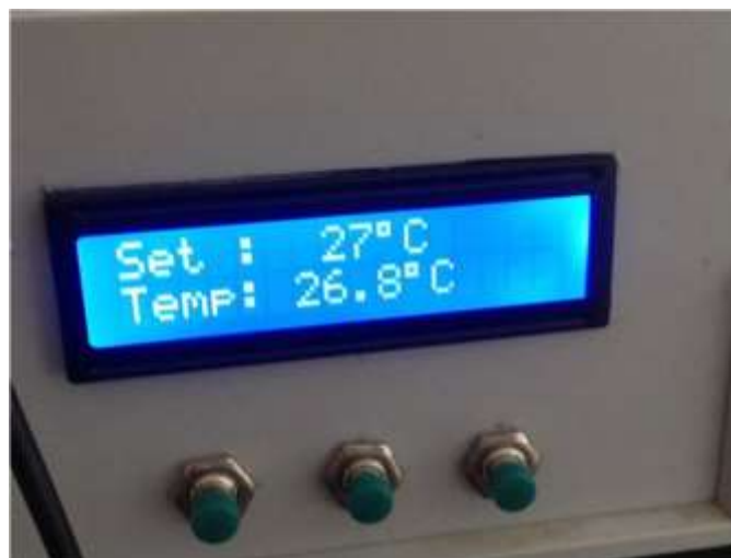
ภาพที่ 4.6 แสดงอุณหภูมิที่เครื่อง Set ไว้ 27°C และอุณหภูมิปัจจุบันในคอกลูกสุกร 26°C
