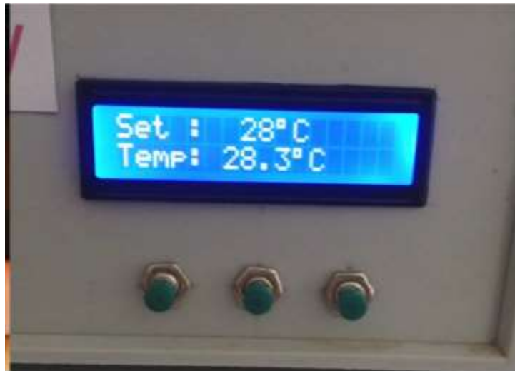
ภาพที่ 4.5 แสดงอุณหภูมิสูงจากพื้น 20 cm. ด้วยชุดควบคุมอุณหภูมิ โดยใช้เซนเซอร์ DS1820
