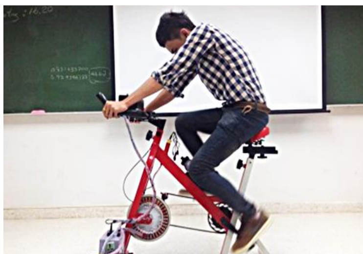
ภาพที่ 4.1 การทดลองปั่นจักรยานออกกำลังกายวัดแรงดันขณะไม่มีโหลด
