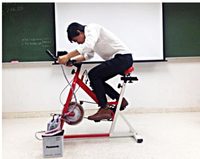
ภาพที่ 4.3 การทดลองปั่นจักรยานออกกำลังกายขณะมีโหลด (แบตเตอรี่)
