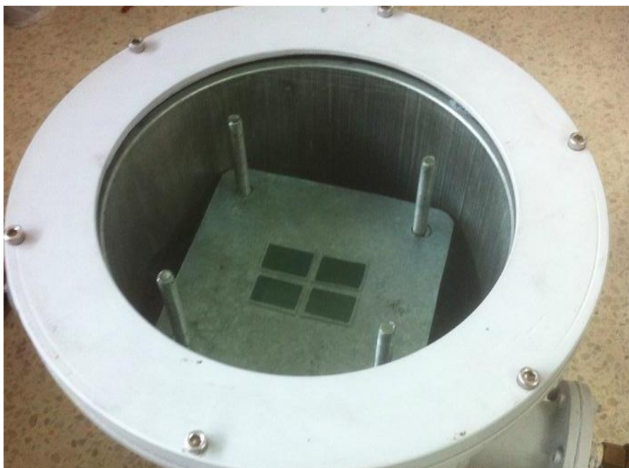
ภาพที่ 3.12 แสดงการจัดวางกระจก ITO บนตะแกรงโลหะเหนือไส้ความร้อนที่ใส่ผง ทั้งสแตนออกไซด์
