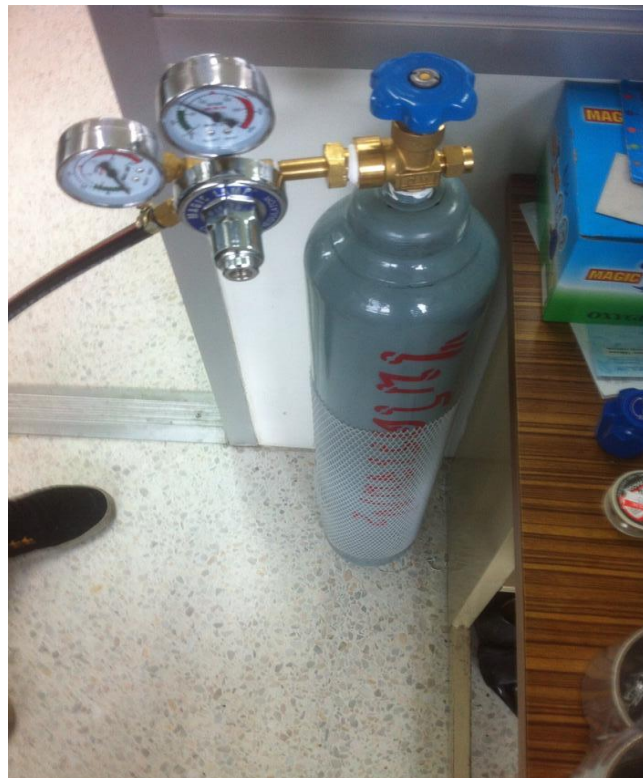
ภาพที่ 3.17 แสดงมาตรวัดปริมาณภายในถังไนโตรเจน
