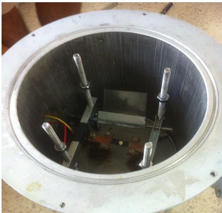
ภาพที่ 3.11 แสดงการวางจัดวางแผ่นปิดกัน Shutter
