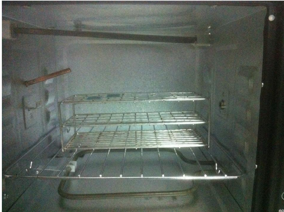
ภาพที่ 3.16 แสดงการนำกระจกที่เคลือบสารทั้งสแตนเลสออกไซด์ เข้าเตาอบ
