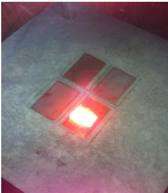
ภาพที่ 3.14 แสดงการให้ความร้อนกับผงทังสเตนออกไซด์เพื่อให้เกิดเป็นไอจับที่กระจก ITO
