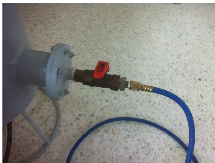
ภาพที่ 3.7 แสดงวาล์วควบคุมความดันใช้กั้นอากาศหลังจากดูดอากาศออก
