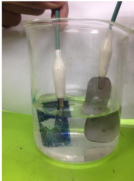
ภาพที่ 4.15 แสดงการทดลองการตอบสนองของสัญญาณกระแสไฟฟ้า ระหว่าง EC กับ ขั้วโลหะ
