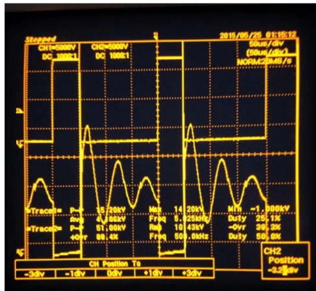
ภาพที่ 4.19 แสดงสัญญาณขาเข้า CH I = 40 V และขาออก CH II ที่ความถี่ 5 kHz, Duty 25%
