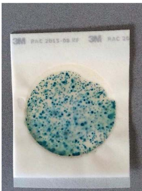
ภาพที่ 4.49 แสดงจำนวนเชื้อจุลินทรีย์ของน้ำคลองบางบัว หลังผ่านการทดสอบที่ความถี่ 20 kHz Duty Cycle 15% เป็นเวลา 10 นาที
