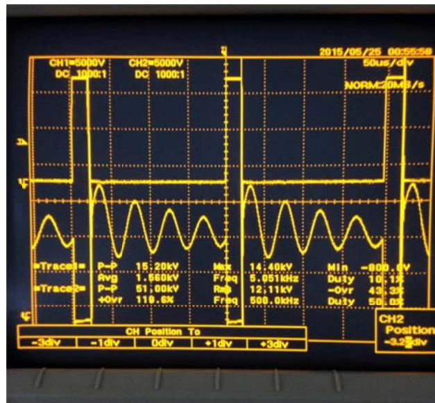
ภาพที่ 4.8 แสดงสัญญาณขาเข้า CH I = 30 V และขาออก CH II ที่ความถี่ 5 kHz, Duty 10%
