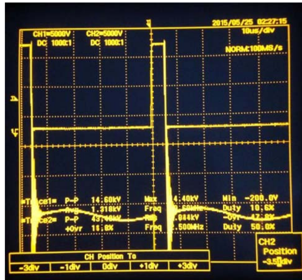
ภาพที่ 4.38 แสดงสัญญาณขาเข้า CH I = 10 V และขาออก CH II ที่ความถี่ 20 kHz, Duty 10%
