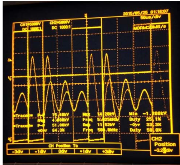
ภาพที่ 4.20 แสดงสัญญาณขาเข้า CH I = 50 V และขาออก CH II ที่ความถี่ 5 kHz, Duty 25%
