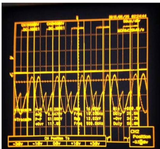
ภาพที่ 4.36 แสดงสัญญาณขาเข้า CH I = 50 V และขาออก CH II ที่ความถี่ 10 kHz, Duty 25%
