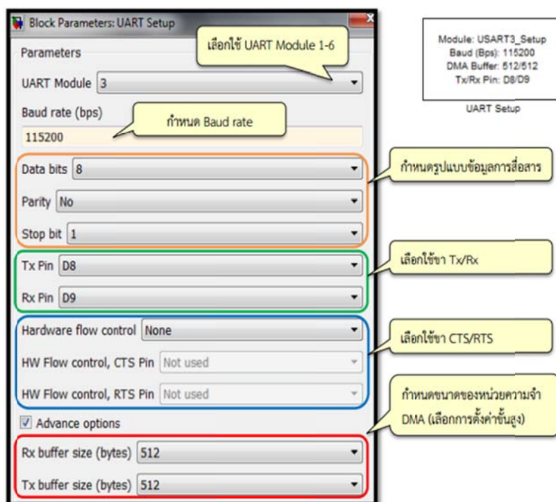
ภาพที่ 3.36 ลักษณะและการตั้งค่าการใช้งาน UART Setup Block
