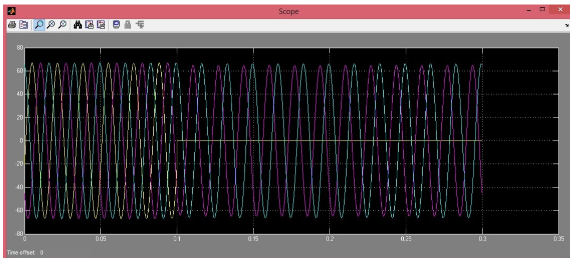
ภาพที่ 4.9 รูปคลื่นแรงดัน ณ จุดเกิดการลัดวงจรแบบ Phase to Ground Fault
