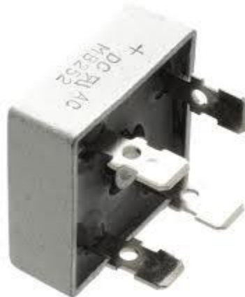
ภาพที่ 3.17 บริดจ์เรกติไฟเออร์ แปลงไฟจาก AC เป็น DC
