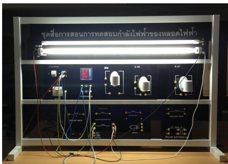
ภาพที่ 4.6 แสดงการต่อวงจรหลอดฟลูออเรสเซนต์
