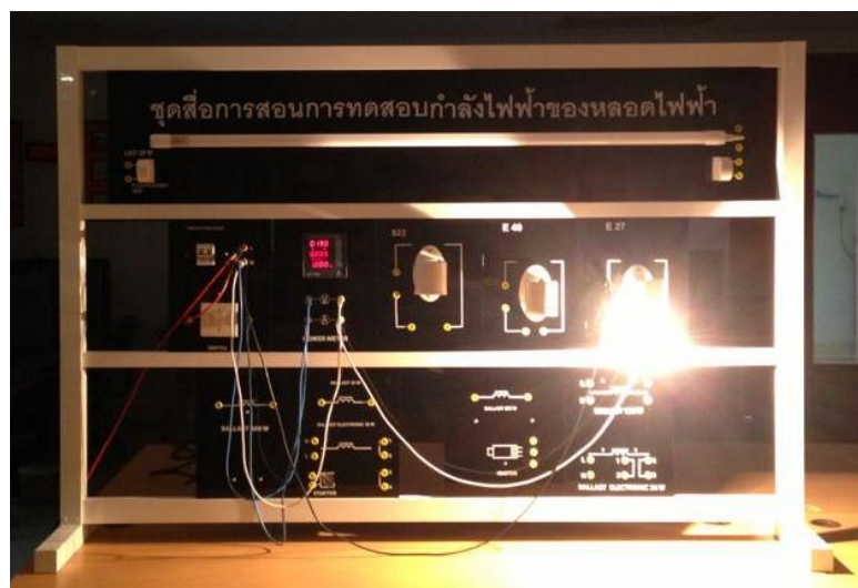
ภาพที่ 4.2 แสดงการต่อวงจรหลอดอินแคนเดสเซนต์
