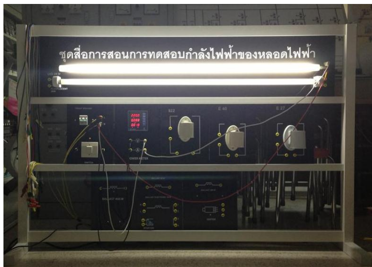
ภาพที่ 4.4 แสดงการต่อวงจรหลอดไดโอดเปล่งแสง
