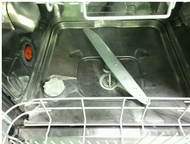
ภาพที่ 4.4 โครงสร้างภายในของเครื่องล้างจานอัตโนมัติ กรองเศษอาหารหัวจ่ายสปริงเกอร์ (Sprinkle)
