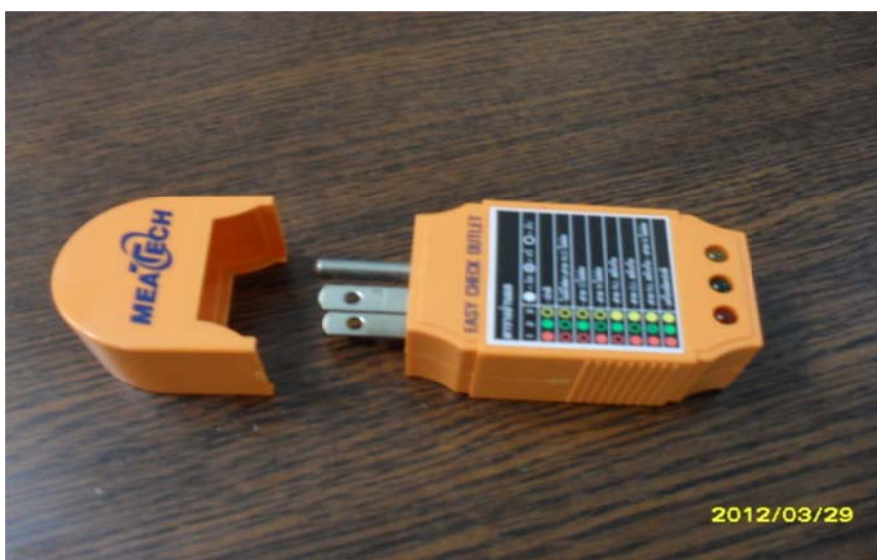
ภาพที่ 2.2 เครื่องตรวจสอบขั้วเต้ารับชนิดมีสายดิน
