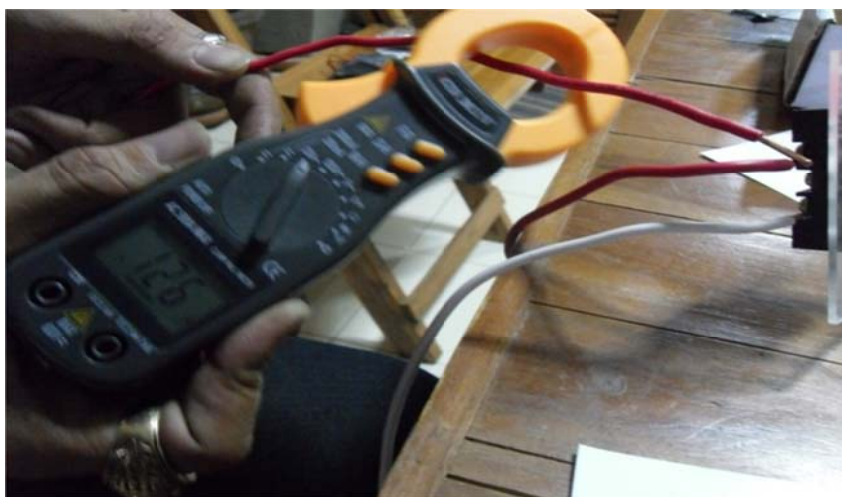
ภาพที่ 4.11 การทดลองกระแสรั่วลงน้ำ
