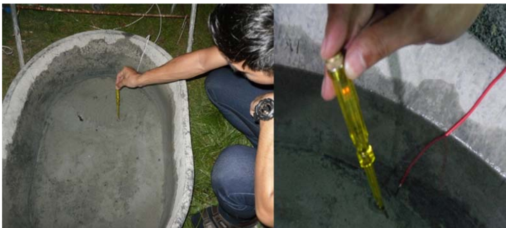
ภาพที่ 4.10 การต่อให้ไฟรั่วลงน้ำ
