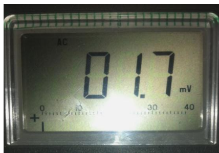
ภาพที่ 4.2 ค่าแรงดันกระแสสลับที่วัดได้จริงจากวงจร
