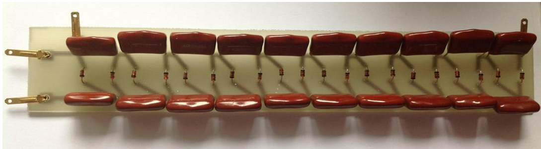
ภาพที่ 4.6 แบบจริงของวงจรทีวีแรงดันไมลาร์
