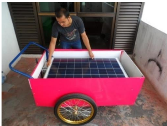
(ก) จับแผงเพื่อทำการตั้งแผงโซล่าเซลล์
