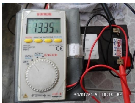
ภาพที่ 4.12 แสดงการวัดค่าแรงดันจากแบตเตอรี่
