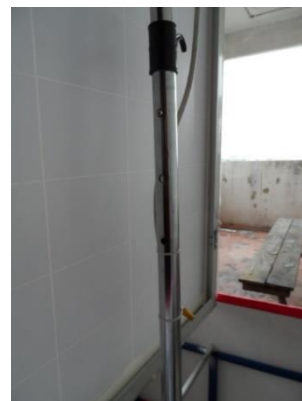
(ข) จุดล็อกมี 3 ระดับเพื่อสามารถปรับความสูงของแผงโซลาร์เซลล์
