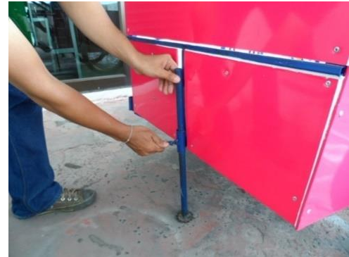
(ข) ล็อคขาตั้งรถเข็นด้วยตัวหมุนยึด
