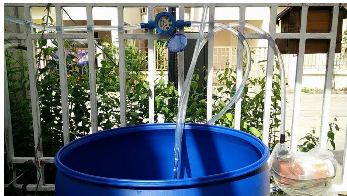
ภาพที่ 4.10 แสดงการทดสอบการเก็บข้อมูลปริมาณน้ำที่ได้ภายใน 1 วัน โดยใช้มิเตอร์น้ำเป็นตัววัด
