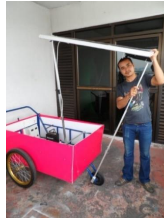
(ข) นำขาค้ำแผงติดตั้งเพื่อสามารถปรับองศาของโซลาร์เซลล์
