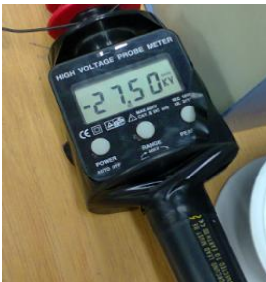
ภาพที่ 4.5 วัดแรงดันอินพุต ที่ V_{in} = 27 V_{dc} ได้แรงดันเอาต์พุต V_{out} = 27.50 kV_{dc}
