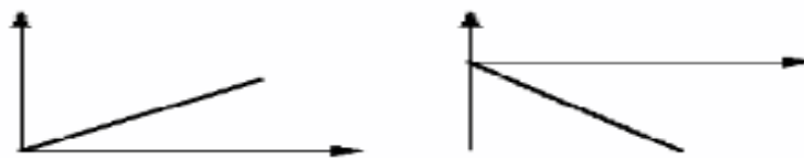
ภาพที่ 2.11 ฟังก์ชันลาดเอียงแบบบวกฟังก์ชันลาดเอียงแบบลบ
