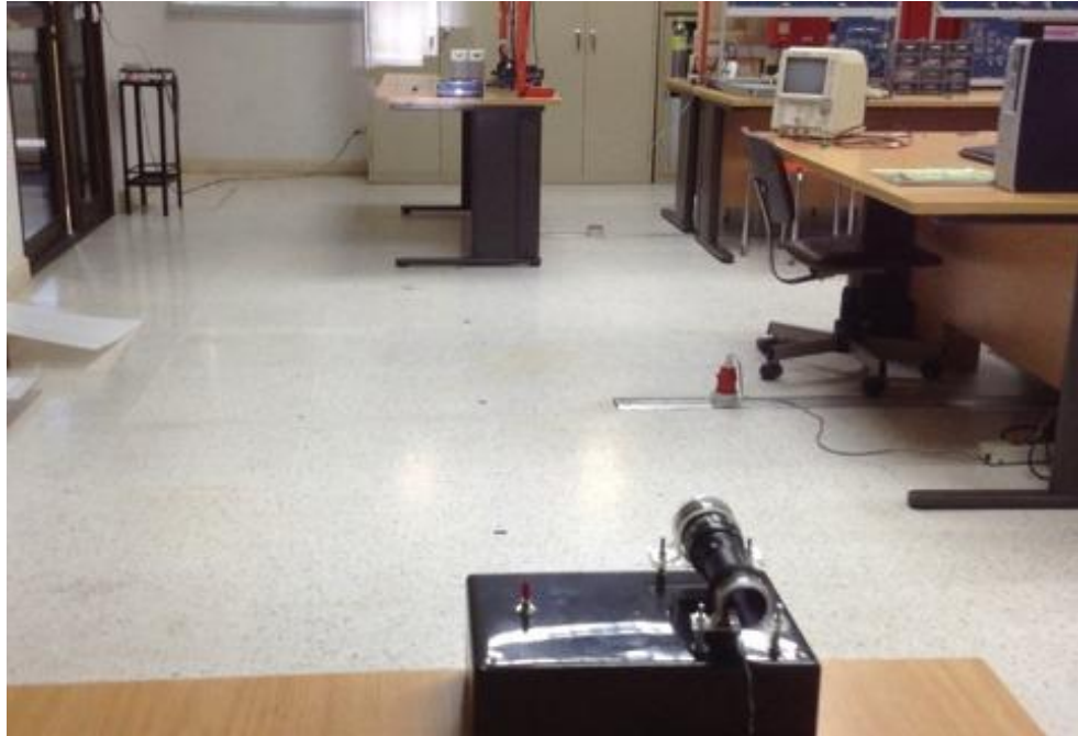
ภาพที่ 4.11 การทดลองส่งสัญญาณเสียงผ่านแสงแบบไร้สาย
