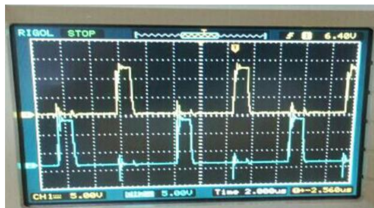
ภาพที่ 4.3 แสดงสัญญาณขณะ No Load วัดที่จุด A และจุด B
