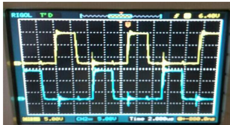
ภาพที่ 4.4 แสดงสัญญาณขณะต่อโหลด วัดที่จุด A และจุด B
