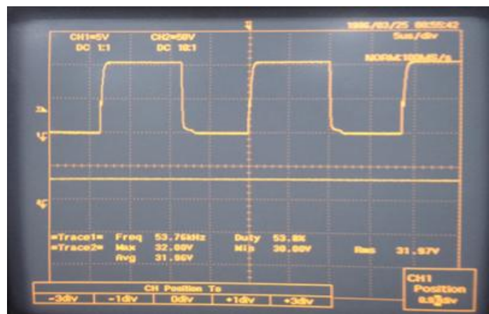
ภาพที่ 4.2 แสดงคลื่นสัญญาณของวงจรขับเพาเวอร์มอสเฟสขณะทำการบัสต์
