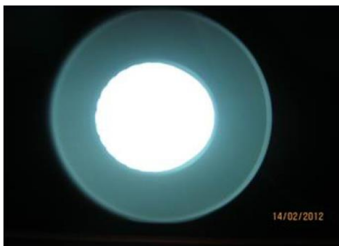
ภาพที่ 3.10 การเอ็กซ์เรย์รูปด้านตัดของตัวนำและฉนวนของสายเคเบิลที่เกิดเบรกดาวน์
