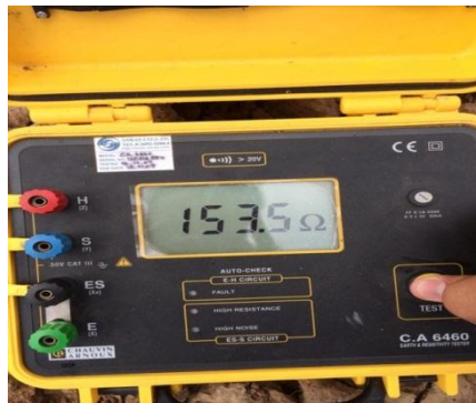
ภาพที่ 3.1 เครื่องมือวัดความต้านทานดิน R_{ac}
