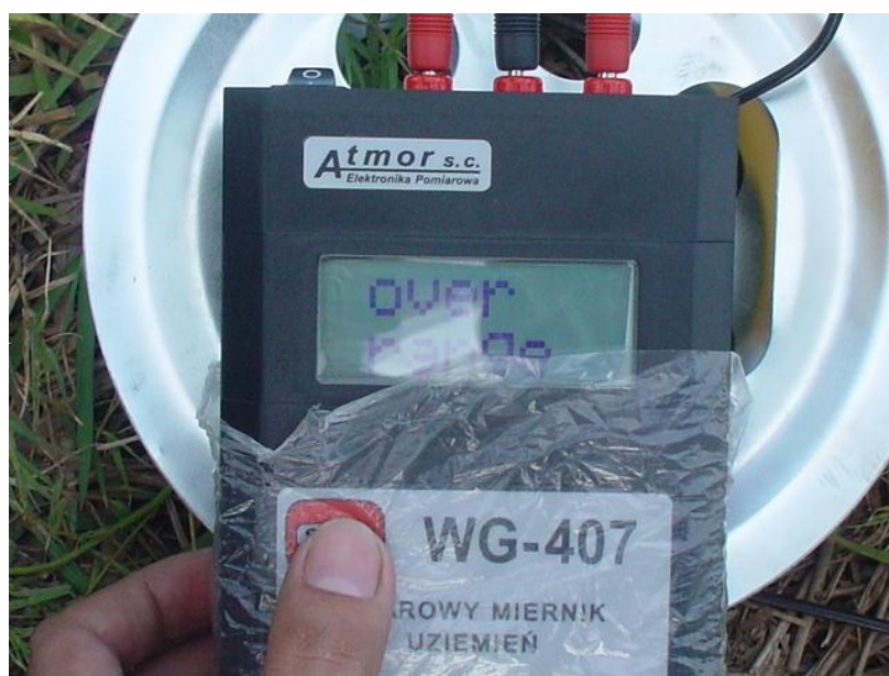
ภาพที่ 3.5 การทดสอบความต้านทานอิมพัลส์ R_{impulse}
